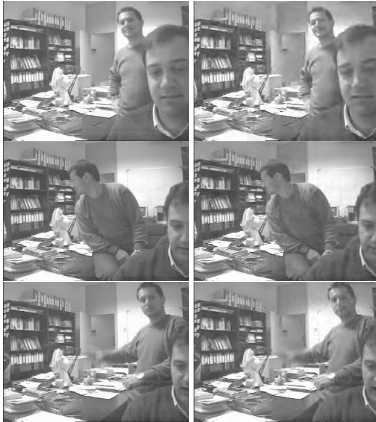
Figura 4.12: Fotogramas de “Charla” a 256 kbps. La primera columna corresponde a MPEG-1, mientras que la segunda columna corresponde a PVC.
